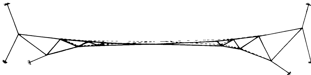
Fig.5 Copia video della trave deformata sulla pretensione iniziale (in tratteggio) per carico verticale
