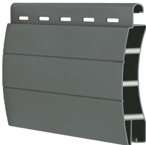
Avvolgibile in PVC ultraresistente grazie al rinforzo in pvc brevettato che garantisce maggiore stabilità della forma anche in condizioni di notevole riscaldamento non essendo più necessaria l'applicazione del rinforzo metallico. Il prodotto è interamente ecosostenibile e rispettoso dell'ambiente essendo riciclabile in tutte le sue parti.
