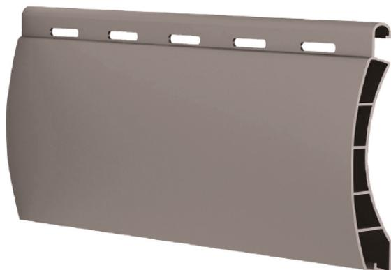
Avvolgibile in PVC realizzato con stecche autoaggancianti a doppia parete. Il profilo è dotato di un fermo laterale anti-sfilamento che serve a bloccare le stecche. Il design sottile garantisce minor ingombro con la stessa resistenza.
