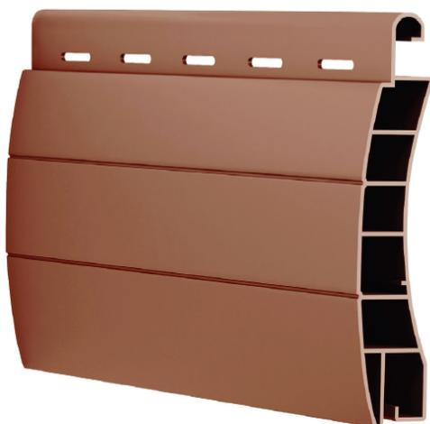
Avvolgibile in PVC realizzato con stecche autoaggancianti a doppia parete che misurano 12 cm alla base e 55 cm in altezza. Il profilo è dotato di un fermo laterale anti-sfilamento che serve a bloccare le stecche. Normalmente viene fornito compreso di rinforzi in ferro ad H.
