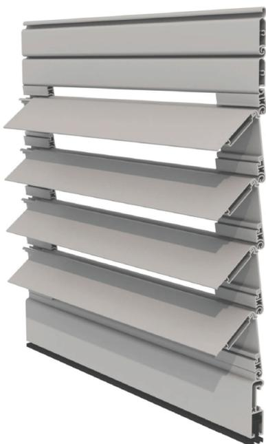
ORIENTAL è un avvolgibile in alluminio estruso a lamelle orientabili, che ti permette di arieggiare, illuminare e proteggere dal sole in tutta sicurezza. Per larghezze superiori a 1,5 m verrà inserito un supporto intermedio. Il prodotto è disponibile solo in versione motorizzata. (Verificare che la larghezza interna della guida sia superiore a 19 mm).
