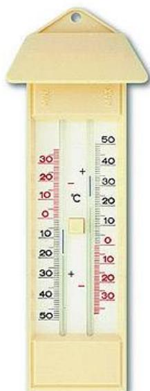
*Doppio termometro con due scale con cursore, per misurare la temperatura istantanea e "ricordare" il picco minimo e massimo.*
