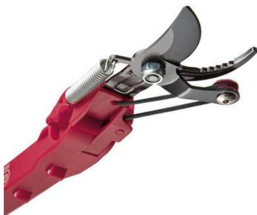
*Svettatoio sniper by-pass, lama in acciaio al carbonio legato temperato HRC 54-56, rivestimento antiaderente in fluoro Polimeri, controlama in acciaio al carbonio temperato HRC 53-55 con dentatura antiscivolo, manico telescopico in alluminio anodizzato dotato di nervatura che consente il passaggio della corda e nello stesso tempo lo rende più rigido alla flessione.*
