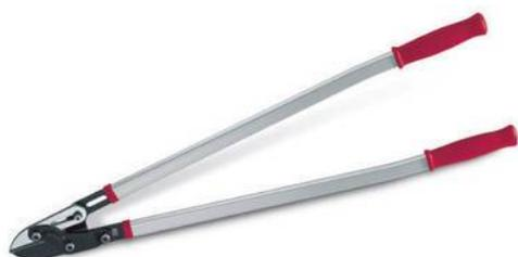
*Forbice troncarami a lama dritta battente, lama dritta in acciaio al carbonio temperato HRC 54-56 resistente a sforzi intensi con filo convesso e lucido per una maggiore penetrazione sui rami secchi, controlama in acciaio al carbonio temperato HRC 52-54, impugnatura ergonomica in plastica gommosa antiscivolo, bullone in acciaio temperato con fermadado, ammortizzatore in plastica gommosa per ridurre i contraccolpi, art.15.*
