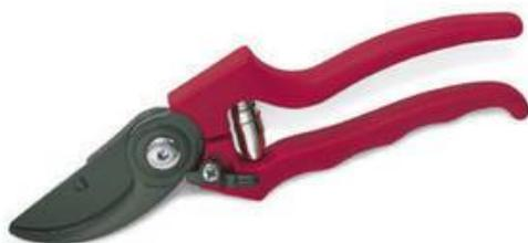
*Forbice per potatura vigna a lama intercambiabile, lama in acciaio al carbonio legato e temperato HRC 54-56. Lama interamente rivestita in teflon per proteggere dalla ruggine e ridurre notevolmente lo sforzo di taglio, controlama e portalama brunite in acciaio al carbonio temperato, impugnatura ergonomica in plastica gommosa antiscivolo.*
