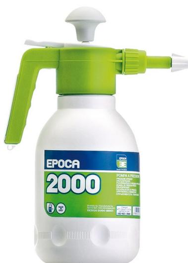
*Dispositivo brevettato di blocco dell'erogazione e getto continuo, pressione massima di lavoro a 3 bar, ugello regolabile da fine nebulizzazione a getto diritto, gittata max 7 metri, Epoca 2000 è dotata di asta pompante in metallo e valvola a spillo in ottone.*
