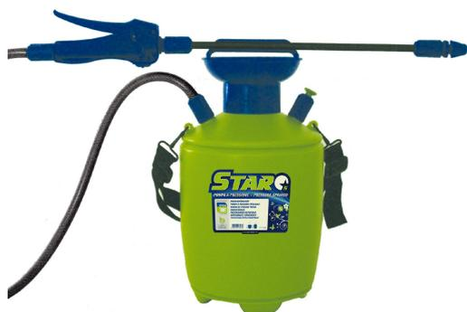
*Linea di pompe a pressione con sistema pompante in plastica, imbuto con ampia apertura per un facile riempimento e confortevole tracolla regolabile, pressione massima di lavoro 3 bar e valvola di sicurezza per depressurizzazione automatica, lancia in plastica cm 40,5.*
