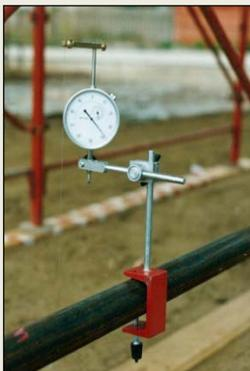
Sopra e a sinistra: prova di carico su viadotto in c.a.p.
