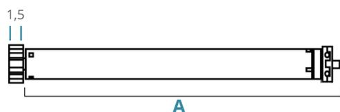
**ELETTRA TRE** è il motore tubolare Ø 45 mm ideale per **tapparelle orientabili**; la regolazione dei limiti di funzionamento avviene tramite **tre fine corsa elettronici e ricevente integrata**.
