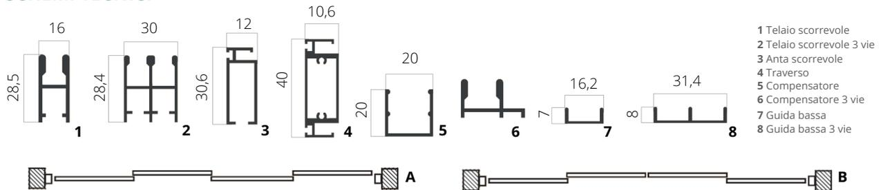
La tipologia di apertura standard per la versione scorrevole a quattro ante è la **A**, le ante sono disposte a scacchiera e si chiudono accavallandosi due a dx e due a sx. E' possibile chiedere la versione **B** in cui le due ante centrali si chiudono in maniera frontale
